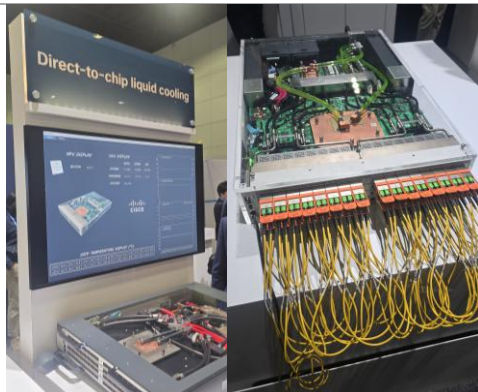
그림 6. CISCO의 Direct-to-Chip 액체 냉각 시스템
